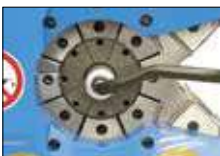
Radiale Zuführbarkeit der Werkstücke auch für 90°-Bögen.
