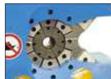
Radiale Zuführbarkeit der Werkstücke auch für 90°-Bögen.
