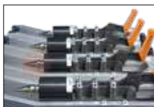
Axial verstellbares Schnellwechselsystem mit justierbarem Drehkopf.
