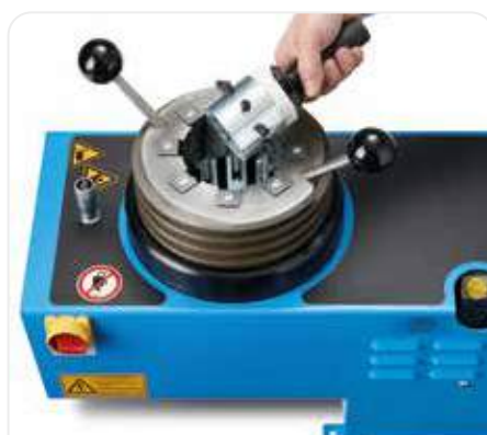
Schnelles Einsetzen der Backen
