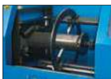
Doppelarm-Schneidewerkzeug mit Schlauch.
