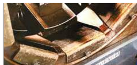
Gleitlager im Zustand nach ca. 900.000 Pressungen
