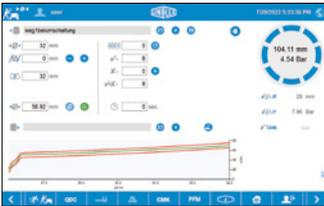
Die PFM-Funktion ermöglicht die permanente Überwachung des Pressdruckes bzw. des Pressdurchmessers während der Fertigung. Verläßt ein Parameter den angelernten Soll-Bereich wird die Verpressung sofort gestoppt und dem Bediener eine Meldung angezeigt. Damit können fehlerhafte Bauteile bereits während der Produktion mit großer Sicherheit erkannt werden.
