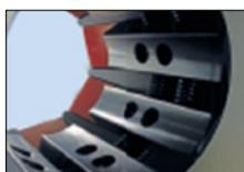
Mit dem neuen Zwei-Loch-System wird das Einsetzen der Pressbacken von beiden Seiten vereinfacht und die Möglichkeit geboten, pro Seite zwei unterschiedliche Positionierungen zu wählen, passend zum jeweiligen Pressbackentyp. Die HM 3 H ist kompakt und bietet eine gute Zugänglichkeit.
