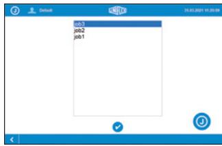
Der Job-Modus ermöglicht ein gesteuertes Abarbeiten von mehreren Aufträgen in der Fertigung. Es ist zudem möglich, mehrere Aufträge aus verschiedenen Datensätzen in der Datenbank in einen Arbeitsauftrag zusammenzuführen. Dazu wird den einzelnen Datensätzen eine Stückzahl zugewiesen.
