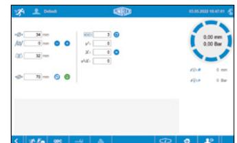
Eingabe von Druck, Haltezeit, Öffnungsdurchmesser, Vorwahlzähler und Pressbacken.
