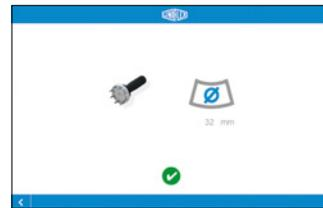
Eingabe von Pressmaßdurchmesser, Korrekturwerten und Pressbacken (automatisch).
